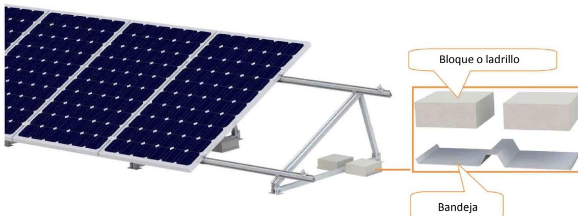
Fig. 5.21: Colocación de bandejas para peso muerto en sistemas verticales.
