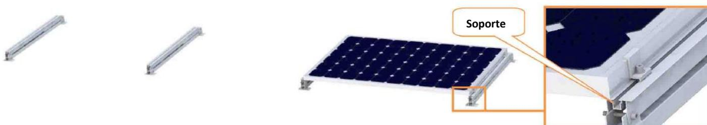
Fig. 5.3: Montaje del primer panel en estructura de 3 piezas horizontales.
