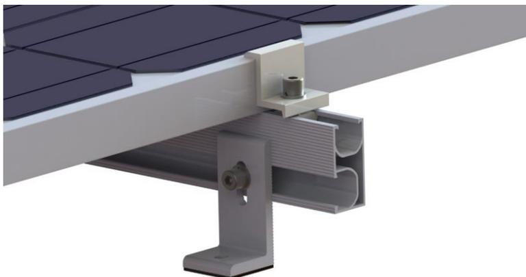
Fig. 5.26: Primer módulo solar en su posición final
