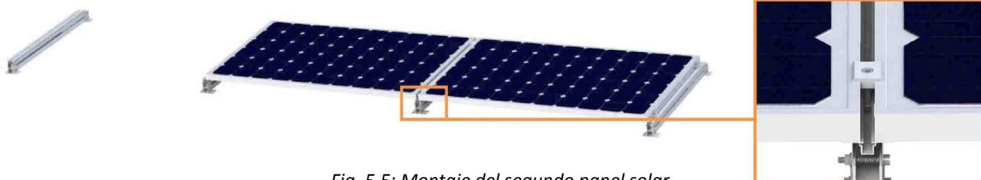
Fig. 5.5: Montaje del segundo panel solar.
