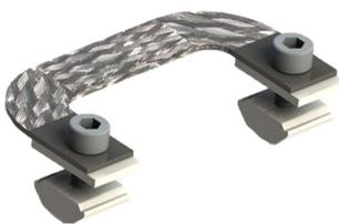
El arnés de aterrizaje LP-BJ permite dar continuidad al sistema de tierra física a la unión entre rieles LP-AR, está fabricado de un listón trenzado de cobre estañado que le otorga flexibilidad, cuenta con un clip de lámina inoxidable para romper el anodizado del riel.
