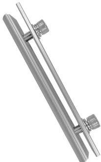
La grapa de unión LP-AR-SP tiene una longitud de 20cm y nos permite unir dos tramos de riel LP-AR para formar un sección más larga, de tal forma que se puedan realizar filas o arreglos de más de 4 módulos
