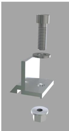
La grapa de aluminio LP-RC- B permite unir el riel LP-AR al soporte pre-ensamblado LA-PAS. Para una unión adecuada de un par de rieles a un soporte pre-ensamblado se requerirán 2 grapas LP-RC-B por soporte triangular.
