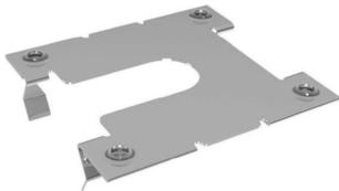
El clip LP-EC permite usar al riel LP-AR como parte del sistema de tierra física, está hecho de lámina de acero inoxidable con pequeñas muescas que rompen el anodizado tanto del marco del módulo como del riel de la estructura. Permite aterrizar hasta dos módulos mediante la grapa intermedia LP-IC.
